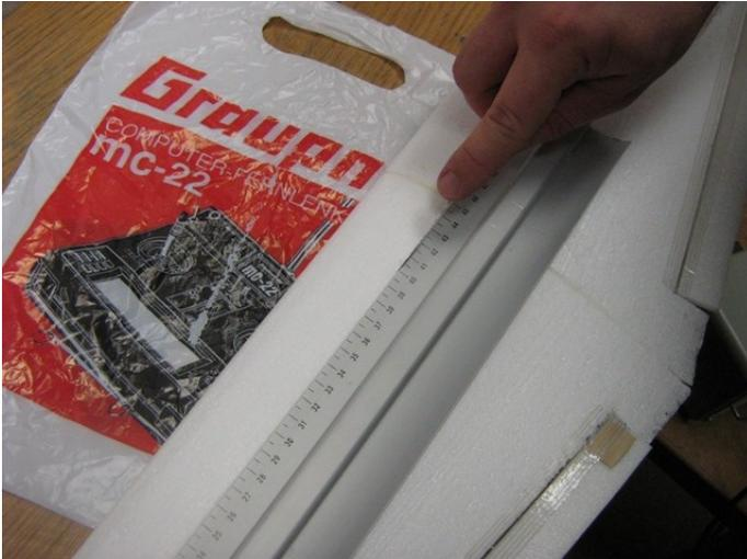
Nach dem Aushärten (mindestens 30 Minuten warten) werden die Kohleprofile eingeklebt. hierfür mittels einem Stahllineal (oder Ähnlichem) und einem Cutter (scharfe Klinge nicht vergessen!) einen Schlitz in die Flächenoberseiten schneiden. Hier wieder die Klinge schräg führen um ein Ausreissen von Styrokügelchen zu vermeiden. den Schlitz etwa 5mm tief setzen.
