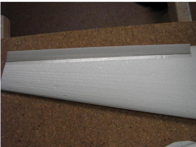
Als Erstes müssen die Querruder schräg angeschliffen werden, damit das Ruder nach unten ausgeschlagen werden kann. Zum Anscharnieren einen Streifen Tape entsprechender Länge auf das Querruder kleben und anschließend das Querruder mit dem Tape an die Fläche. Hierfür auf einen genügenden Abstand des Querruders zur Flächenhinterkante achten, damit ein ausreichend großer Ruderausschlag nach unten erreicht werden kann. Anschließend das Ruder
