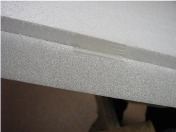
Zum Abschluß der Arbeiten an der Fläche kann zur Versteifung Strapping Tape (glasfaser verstärktes Klebeband) aufgebracht werden. Auch ein Streifen GfK-Matte mit ca. 8cm Breite kann in der Mitte der Flächenunterseite mit Laminierharz auflaminiert werden.
